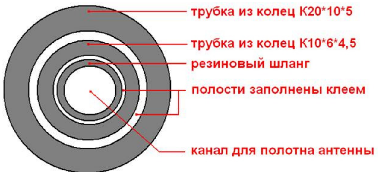
Рис.4. Схема поперечного разреза муфты
